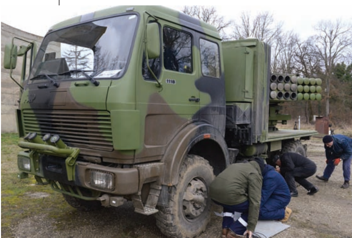
Посиљављање вага које мере силу ослањања
